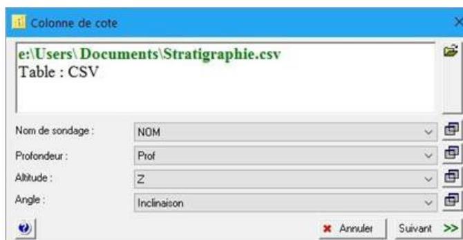
Le cas échéant, s'assurer que l'unité des inclinaisons soit bien en degrés, avec le 0° orienté vers le centre de la terre et le 90° orienté à l'horizontal, comme indiqué sur le schéma ci-dessous.
