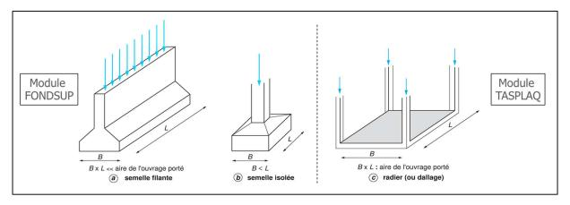
Figure 2: Domaine d'utilisation du module FONDSUP par différence avec celui de TASPLAQ
