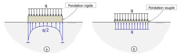
Figure 15: Distribution des contraintes sous une fondation rigide ou souple (Frank et al. 2018)
