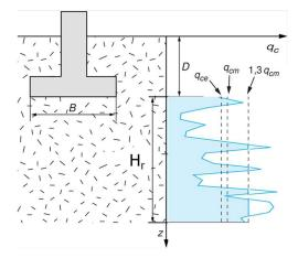
Figure 10 : Principe de calcul de la résistance de cône équivalente
