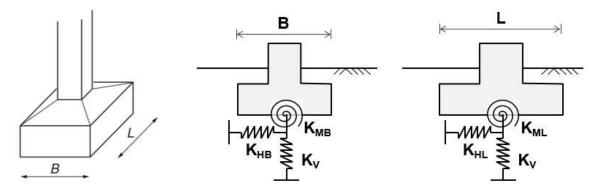
Figure 16: Raideurs équivalentes pour une fondation isolée
