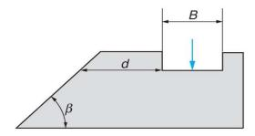
Figure 8 : Présence d'un talus à proximité de la semelle - notations
