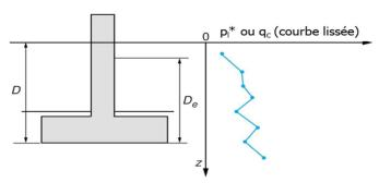
Figure 7 : Notion de profondeur d'encastrement équivalente
