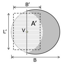
Figure 5 : Définition de l'aire d'assise effective pour une fondation circulaire
