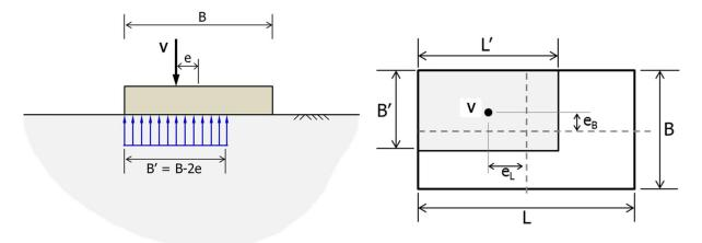
Figure 4 : Définition de l'aire d'assise effective pour une fondation rectangulaire
