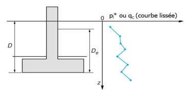
Figure 12 : notion de profondeur d'encastrement équivalente
