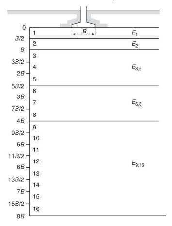
Figure 13: Modèle pressiométrique pour le calcul des tassements
